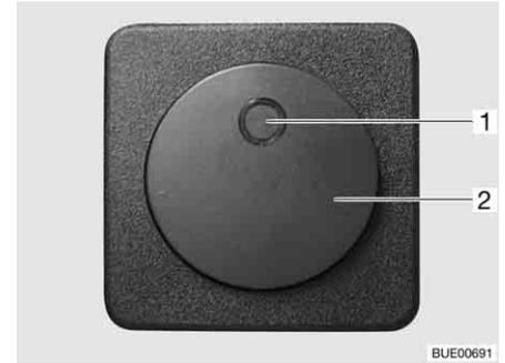
Fig. 118 Interruttore per riscaldamento elettrico del pavimento
