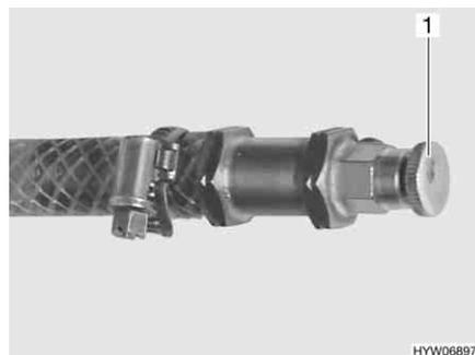
Fig. 196 Valvola di sfiato del riscaldamento ad acqua calda
