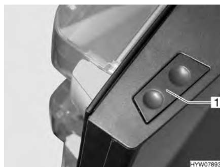
Fig. 146 Tasto di sblocco della porta del frigorifero (serie Dometic 8)
