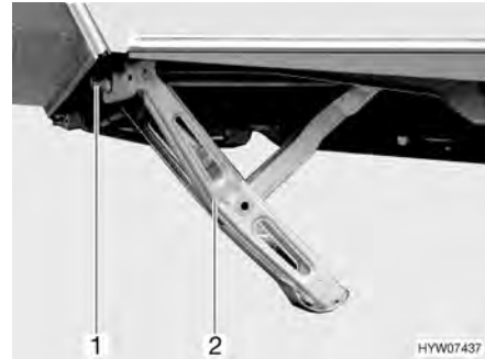
Fig. 19 Piedini di stazionamento a manovella abbassati (variante 2)
