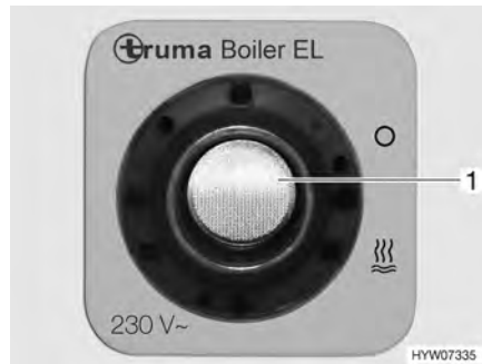
Fig. 132 Interruttore a levetta per boiler Truma (funzionamento elettrico a 230 V)
