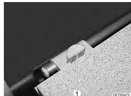
Fig. 69 Bloccaggio del piano del tavolo (variante)
