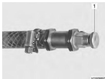
Fig. 200 Valvola di sfiato del riscaldamento ad acqua calda
