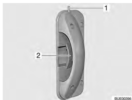
Fig. 28 Serratura della porta di ingresso, lato interno
