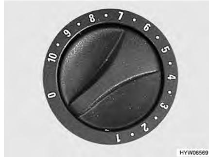
Afb. 114 Draairegelaar aan de verwarming
