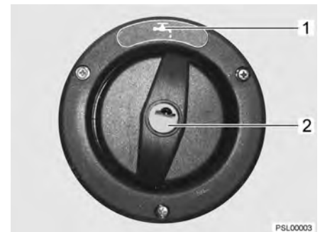
Fig. 155 Bocchettone di riempimento dell'acqua potabile (alternativa)
