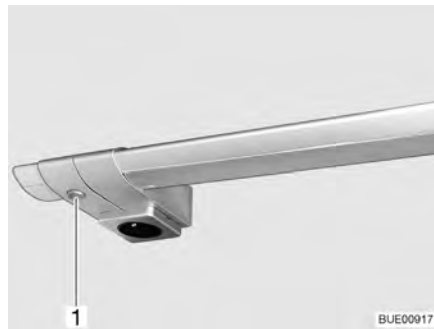
Fig. 47 Luce area cottura, interruttore luci in corrispondenza della lampada
