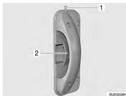
Fig. 28 Serratura della porta di ingresso, lato interno
