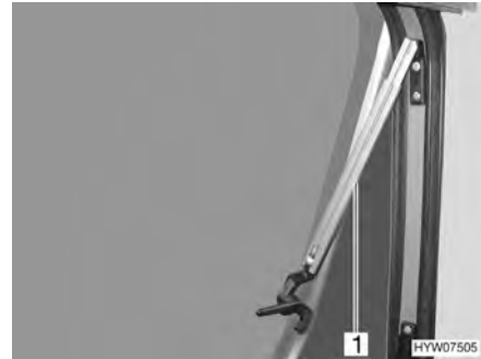
Fig. 56 Ventana abatible con soportes automáticos, abierta
