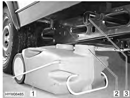
Fig. 21 Depósito de aguas residuales, con ruedas
