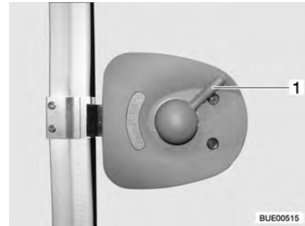
Fig. 25 Cerradura de la puerta de entrada, en el interior, bloqueada
