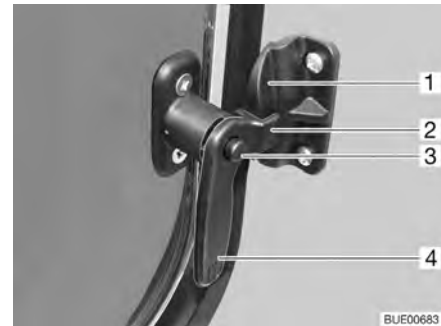
Fig. 30 Ventana de la puerta de entrada en la posición de "ventilación continua"
