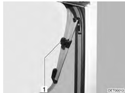
Fig. 53 Ventana abatible con soportes giratorios, abierta
