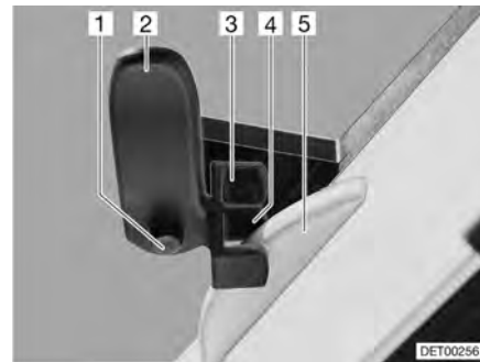
Fig. 64 Claraboya Heki en posición de ventilación 1
