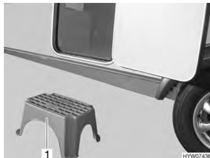
Fig. 20 Escalón de entrada (independiente)
