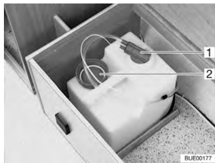
Fig. 152 Depósito de agua 16 l
