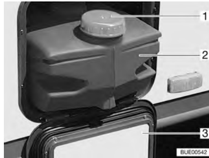
Fig. 153 Depósito de agua 22 l
