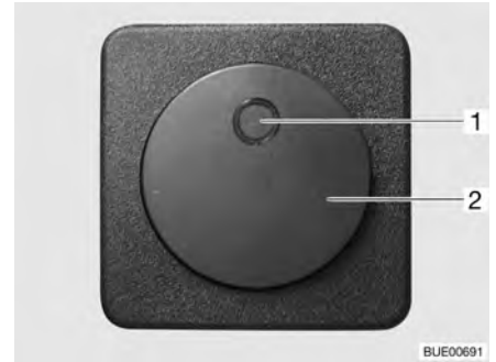
Fig. 125 Interruptor para calentamiento eléctrico del piso
