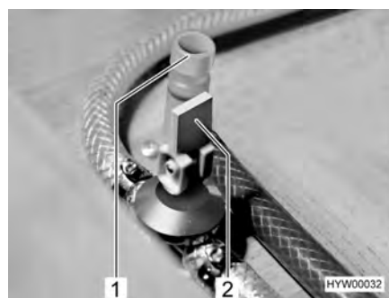
Fig. 132 Llaves de desagüe para la caldera Truma
