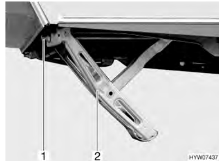
Fig. 19 Apoyo a manivela bajado girando la manivela (variante 2)
