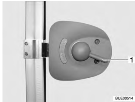
Fig. 24 Cerradura de la puerta de entrada, en el interior, abierta
