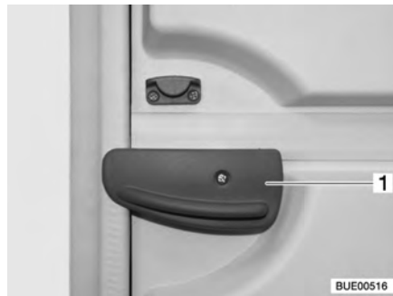
Fig. 26 Palanca de bloqueo en la parte inferior de la puerta
