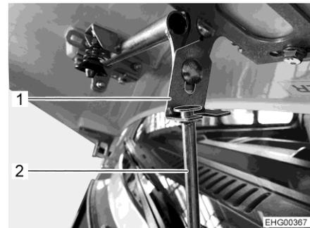
Bild 38 Stütze Motorhaube
