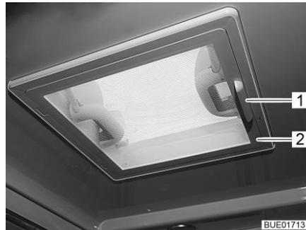
Bild 90 Dachhaube mit Schnappverschluss
