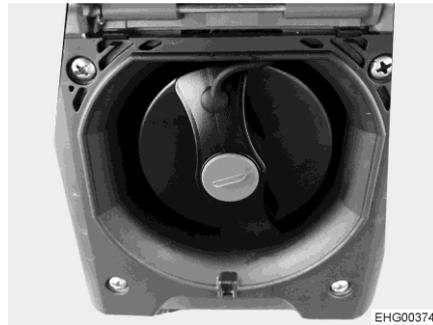
Bild 58 Verschlussdeckel für Trinkwasser-Einfüllstutzen
