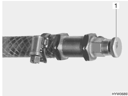
Bild 160 Entlüftungsventil Warmwasser-Heizung
