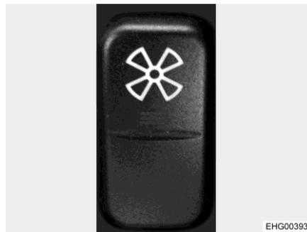
Fig. 136 Auxiliary fan rocker switch
