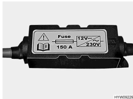
Fig. 119 Fuse (AC converter (150 A))
