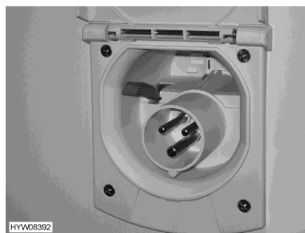
Fig. 138 Raccordement 230 V sur le véhicule
