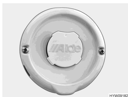
Fig. 166 Cheminée murale (chauffage à eau chaude)
