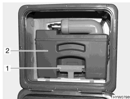
Fig. 196 Réservoir pour matières fécales (exemple)
