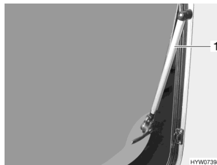
Fig. 89 Fenêtre projetante avec bras automatique
