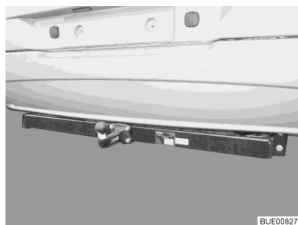
Fig. 6 Dispositif d'attelage, rigide
