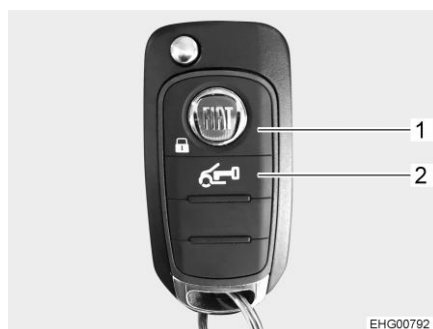
Fig. 53 Télécommande du verrouillage centralisé (2 touches)
