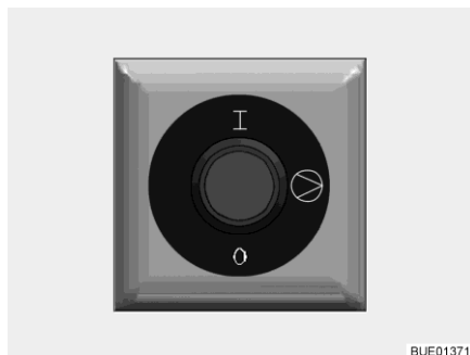
Fig. 164 Commutateur de commande du circulateur supplémentaire
