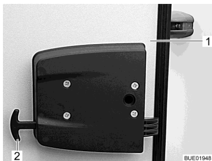
Fig. 62 Dispositif de déverrouillage de secours du portillon de garage
