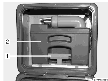
Fig. 204 Réservoir pour matières fécales (exemple)
