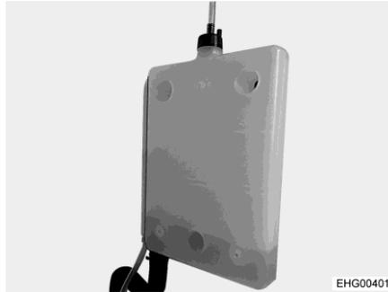
Fig. 208 Recipiente de compensación sin panel
