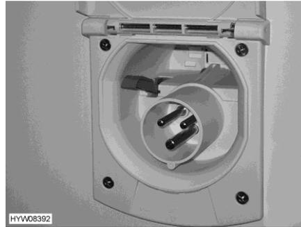
Fig. 138 Conexión de 230 V en el vehículo
