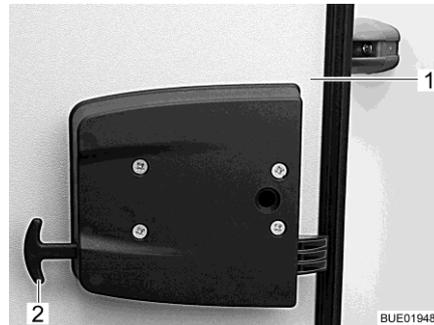
Fig. 62 Desbloqueo de emergencia de la trampilla del garaje
