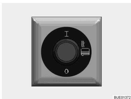
Fig. 193 Interruptor para calefacción de aguas residuales
