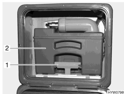
Fig. 196 Depósito de aguas fecales (ejemplo)
