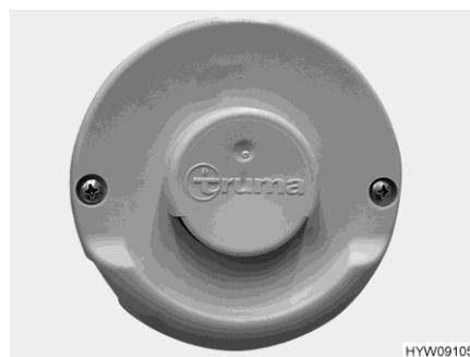
Fig. 167 Tubo de chimenea en la pared (calefacción de aire caliente)
