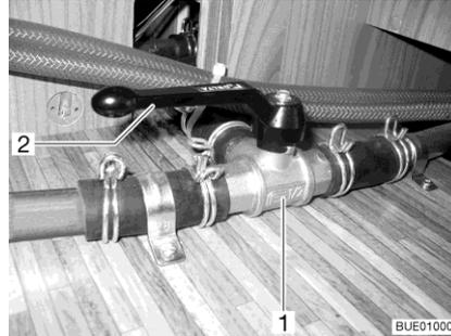
Fig. 161 Válvula de 3 vías
