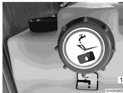
Fig. 181 Símbolo Tubo de llenado de agua potable
