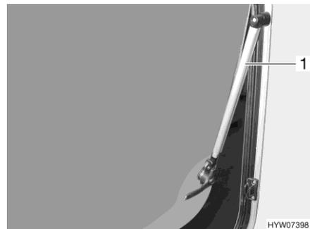
Fig. 89 Ventana abatible con soporte automático
