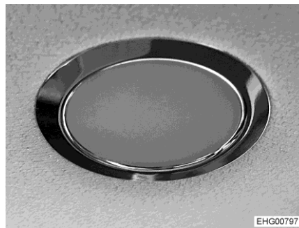
Afb. 219 Inbouwlamp (voorbeeld)
