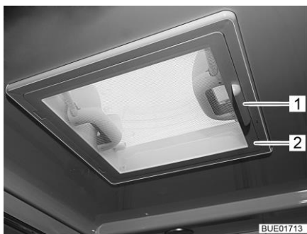
Kuva 98 Kattoluukku jossa on napsautuslukko
