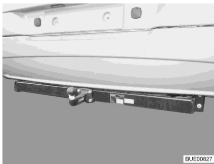
Kuva 6 Perävaunun vetokoukku, kiinnettä
