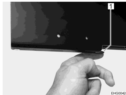
Kuva 85 Kääntömekanismin lukituksen avaaminen
