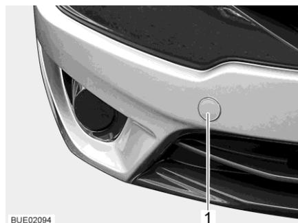
Fig. 48 Copertura per l'alloggiamento dell'occhione di traino (esempio)
