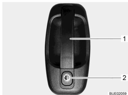
Fig. 55 Serratura della porta (porta conducente, lato esterno)
