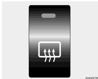
Fig. 38 Interruttore riscaldamento specchietti esterni
