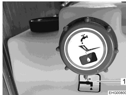
Fig. 181 Simbolo bocchettone di riempimento dell'acqua potabile
