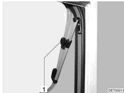
Fig. 88 Finestra apribile con deflettore a rotazione
