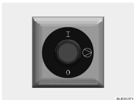
Fig. 164 Interruttore di comando pompa di circolazione aggiuntiva
