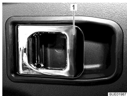
Fig. 56 Serratura della porta (porta conducente, lato interno)
