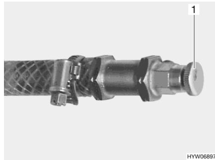
Fig. 209 Valvola di sfiato del riscaldamento ad acqua calda
