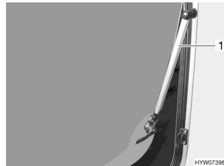
Fig. 89 Finestra apribile con deflettore automatico
