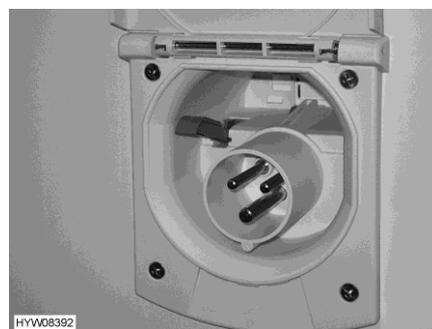
Fig. 138 Collegamento a 230 V al veicolo
