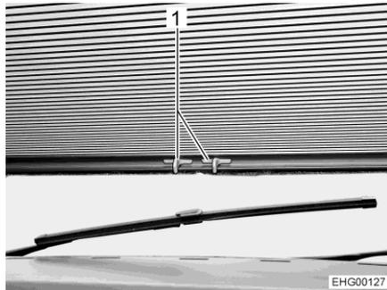
Fig. 39 Tendina oscurante pieghevole (parabrezza)
