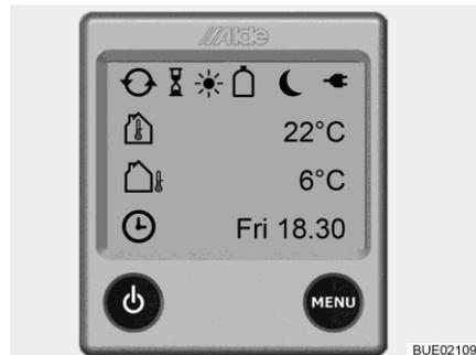
Fig. 158 Schermata iniziale (centrale di controllo)
